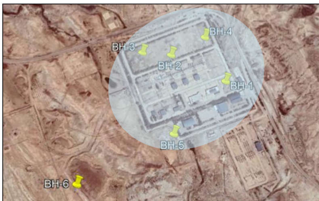
شکل 4-1- گمانه‌های ماشینی در محدوده مورد مطالعه ایستگاه تقویت فشار گاز
