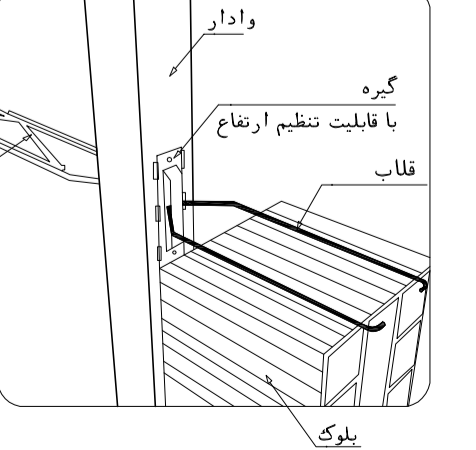
جزئیات اجرایی میانقاب غیرسازه ای دارای باز شو (طبق ضوابط پیوست ششم استاندارد ۲۸۰۰)
