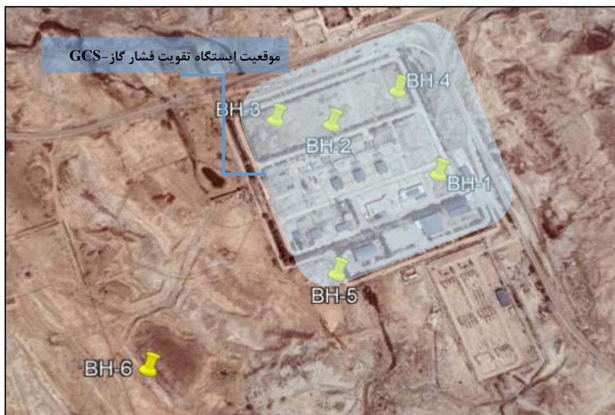
شکل 3-1- جانمایی محل حفر گمانه های ماشینی در ایستگاه تقویت فشار گاز
