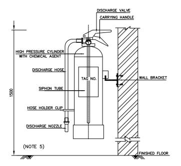
WALL MOUNTED PORTABLE DRY CHEMICAL EXTINGUISHER SIDE VIEW
