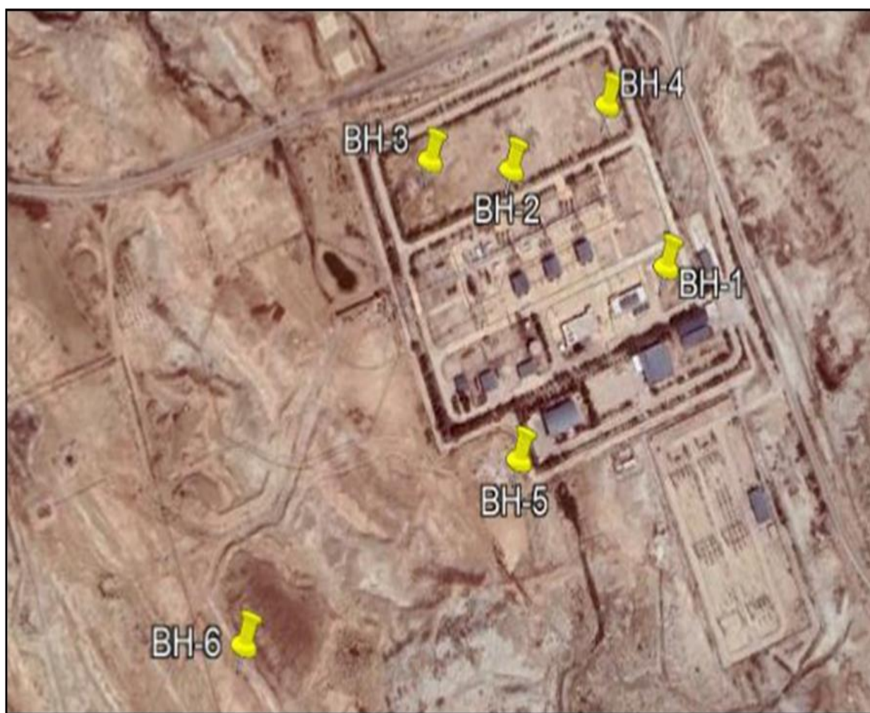
شکل ۱-۱ - موقعیت قرارگیری گمانه‌های ماشینی محل پروژه در ایستگاه تقویت فشار گاز در Google Earth
