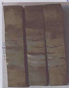
تصویر سطلوح پهن آزمونهای بعد از انجام آزمون HIC.
