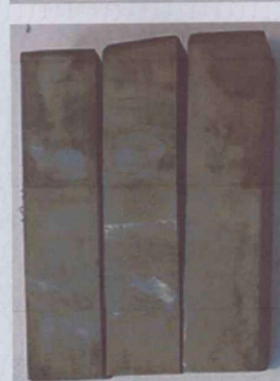
تصویر سطلوح پهن آزمونهای بعد از انجام آزمون HIC.
