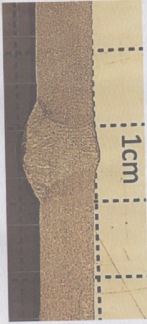
شکل 1. تصویر ماکروسکوپی از مقطع عرضی آماده سازی شده. محللول ظاهر کننده نایتل ده درصد
